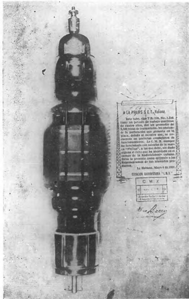
Fotografía tomada a un tubo "Philips tipo T. B. (250, núm. 1648, instalado en la estación radio-emisora C. M. X., de la Casa Lavín, el que a pesar de presentar una gran perforación en la placa tiene un periodo de trabajo continuo de cinco años con un promedio de 4.200 horas de transmisión. Nótese al lado del tubo el certificado que facilitó con fecha 6 de Mayo del pasado año 1931 el señor Francisco Lavín, propietario de la ciudad, planta de radio.
